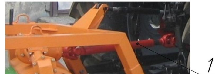
Рисунок 15. Вал карданный УМДУ-01.040.3000-70
